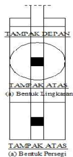
Gambar 2.2 Pondasi telapak tunggal
